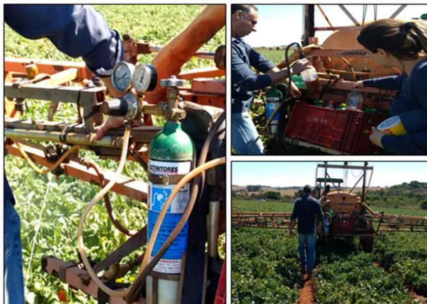
Figura 2.3. Pulverizador costal pressurizado com CO 2 acoplado a barra de aplicação do pulverizador de arrasto, em Morrinhos-GO. Fonte: Vanderli Bertonha Pavan (2018).
